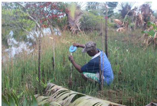
L'équipe du SCRP arpente les zones humides de mahampy. Ils mesurent hauteur et densité des roseaux
